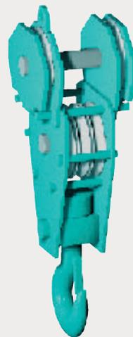
51トンフックは、シーブ3枚の本体部とシーブ2枚の脱着部からなる新構造。2枚シーブを取り外せば、そのまま25トン中間フックとして使用可能。2つのフックを用意する必要がなく、持ち運びも1つでOKです。
