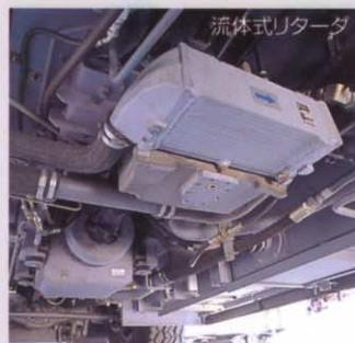
強力な制動力を発揮する油圧空気倍力装置付き4輪ディスクブレーキを採用。しかも補助ブレーキには、新たに5段階の調整が可能な流体式リターダを標準装備。長い下り坂でもフットブレーキの負担を軽くしながら安心して降坂できます。
